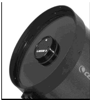
Рис. 7-3. Три юстировочных винта на оправе вторичного зеркала.
