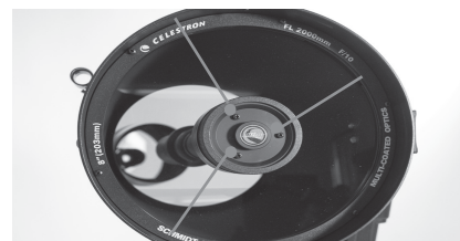
Юстировочные винты вторичного зеркала
