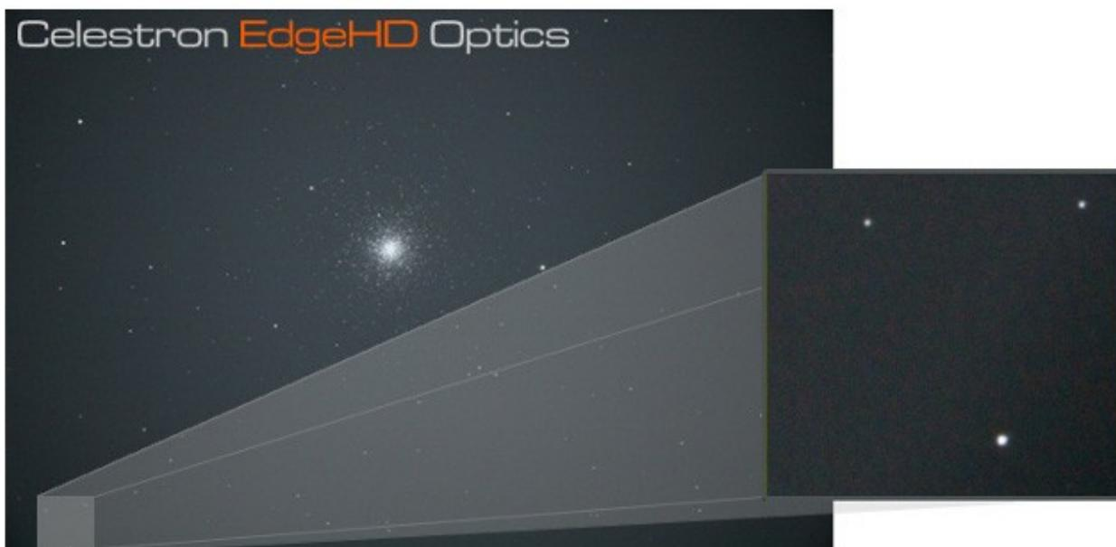
*Рис. 1 (выше). Конкурирующая схема с исправленной комой показывает четкие изображения звезд вблизи центра кадра, но значительно расфокусированные (как бублики) – на краях кадра.*
