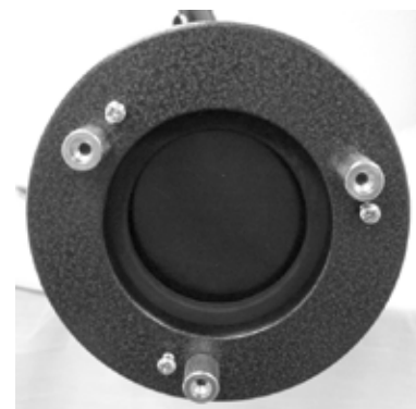
Рис. 5-2. PowerSeeker 114 EQ –оправа главного зеркала
