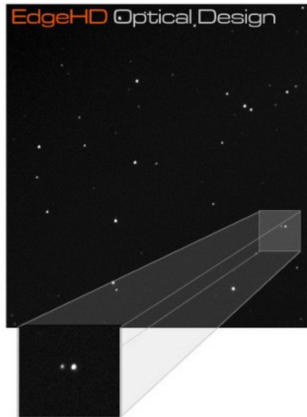
*Рис. 1 (слева). Всеосевая кома присуща многим оптическим схемам (например, телескопам Шмидта-Кассегрена), где она искажает изображения звезд и снижает разрешающую способность.*
