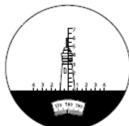
При измерении расстояния оцените ширину или высоту объекта и затем измерьте его угловой размер. Вычислите расстояние до объекта по приведенной формуле.
